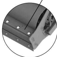
Verstellbarer Scarificatore zur Reinigung der trommel lisca
